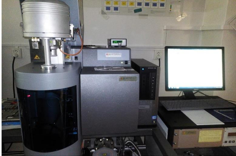
**Figure III.6** L'analyseur thermogravimétrique Setaram Setsys.
