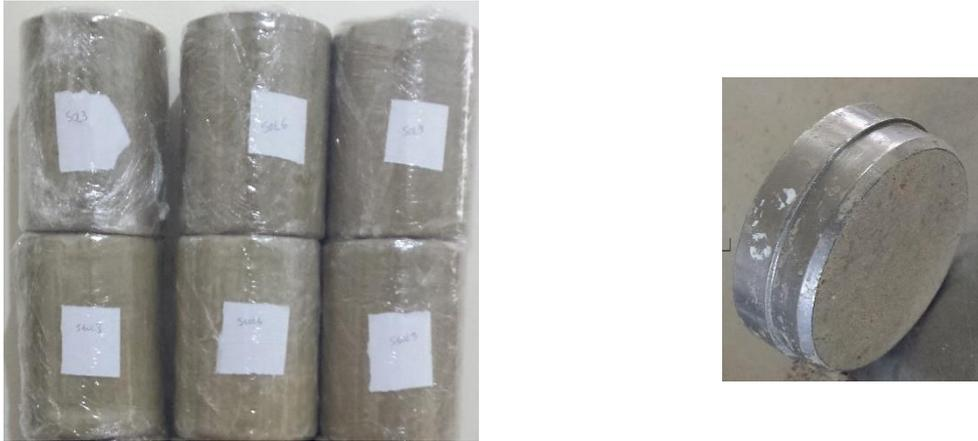
**Figure 3.14** — Compactage et recouverts les échantillons.
