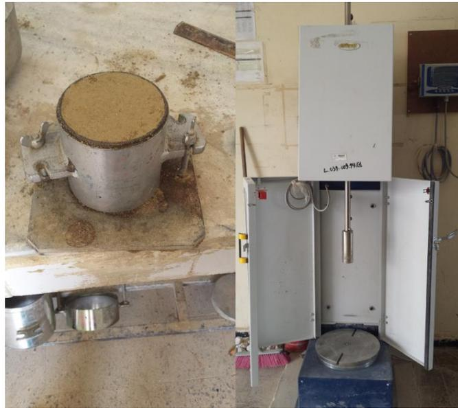
Figure 3.10 — Photographie de l'équipement de l'essai de Proctor.
