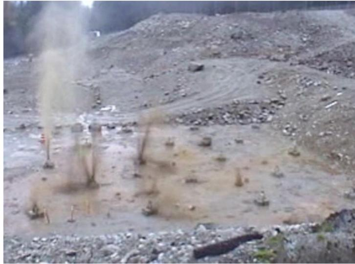
**Figure 1.13** — Exemple de dynamitage sur le terrain montrant l'expulsion de l'excès d'eau interstitielle.
