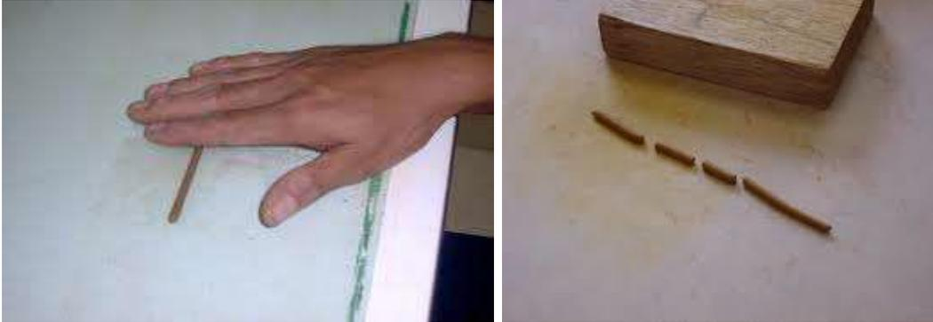
**Figure 3.8** — Photographies montrant le sol dans la limite de plasticité :
