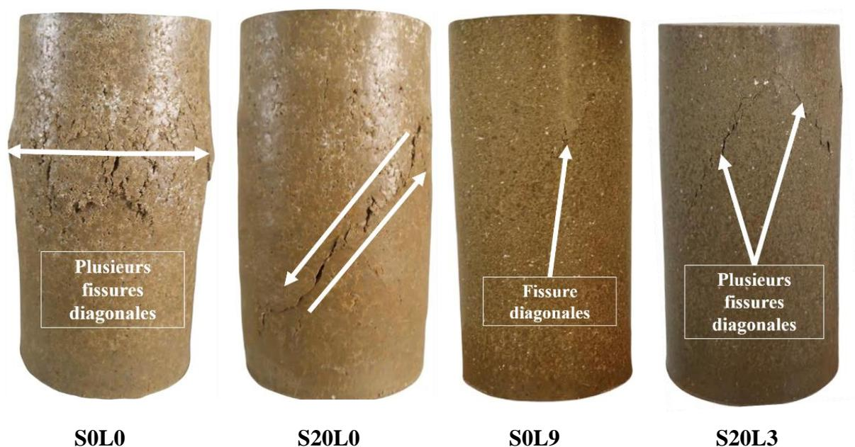
Figure 5.9 — Éprouvettes après rupture.
