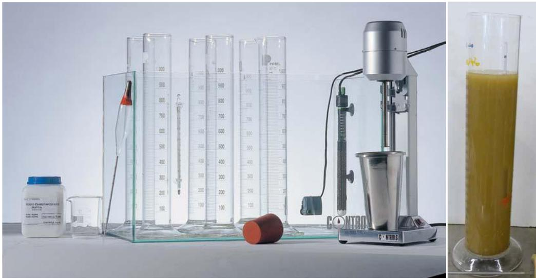
**Figure 3.13** — Photographie de l'équipement de l'essai de tamisage par sédimentométrie.
