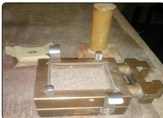
Figure 2.9 : Exemple d'échantillon préparée par la méthode de pluviation à sec (FA = 0%).
