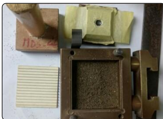
Figure 2.8 : Exemple d'échantillon préparé par la technique de damage humide (FA = 0%).
