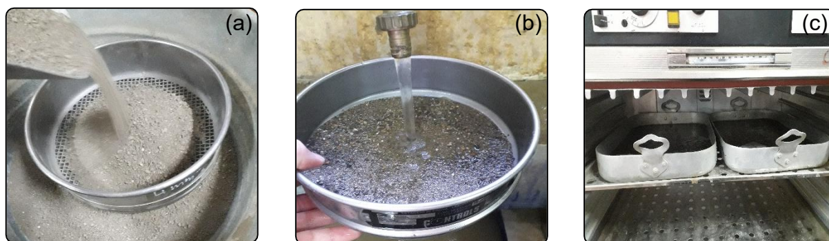
Figure 2.16 : Préparation des échantillons : (a) tamisage ; (b) lavage ; (c) séchage.
