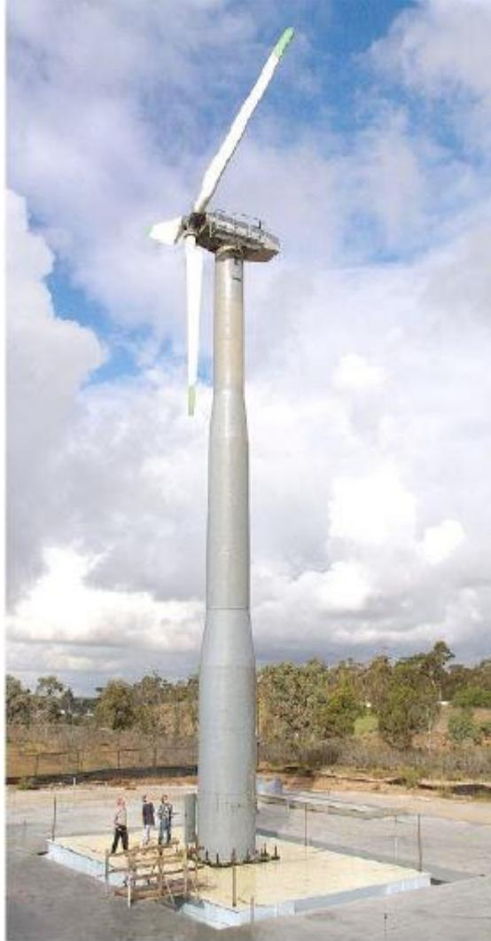
**Figure 4.2.** Eolienne sur table vibrante (Prowell et al., 2008).
