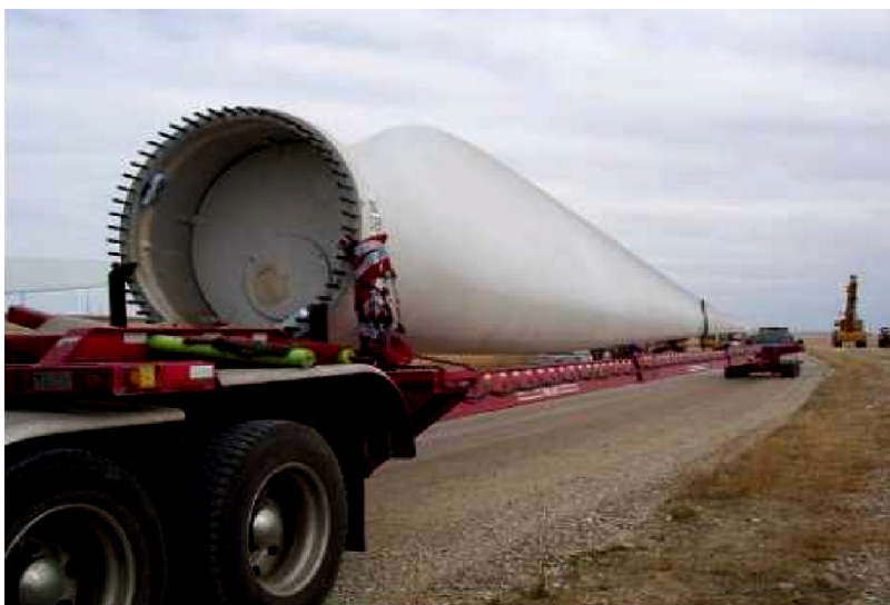
Figure I.11 : Transport de pale d'une turbine éolienne de 1.5MW.
