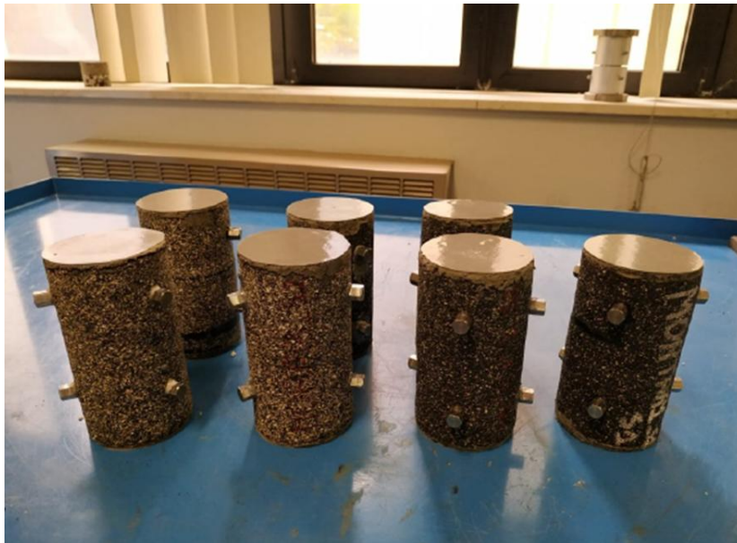
Figure 3. 25 - Aspect des éprouvettes pour les quatre compositions de mortier.
