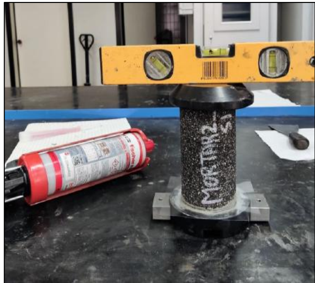
Figure 3. 24 - Mise à niveau des faces de l'éprouvette.
