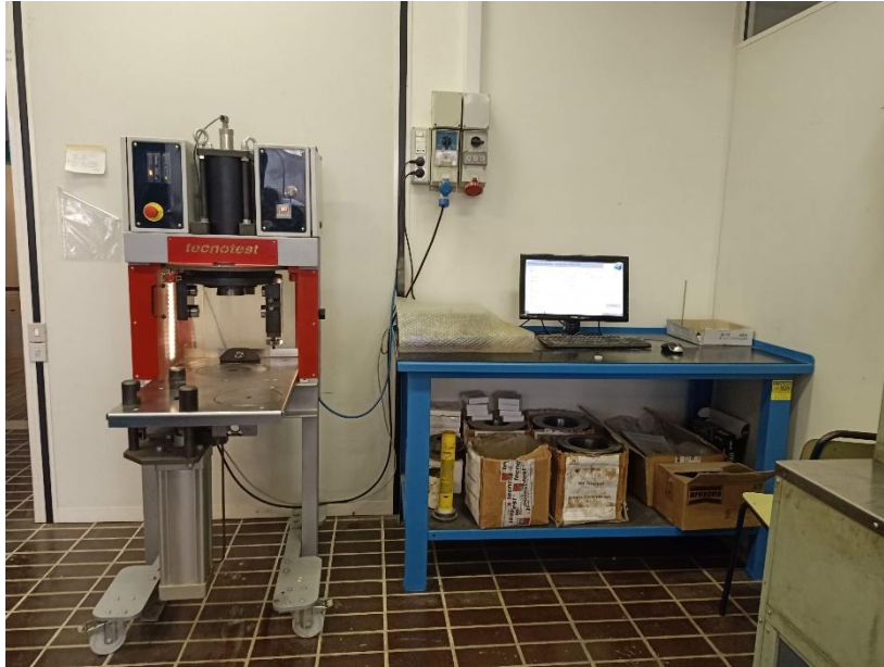
Figure 3. 15 - Le compacteur giratoire à cisaillement utilisés en laboratoire.
