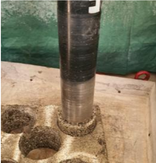
Figure 3. 23 - Carottage de l'échantillon.
