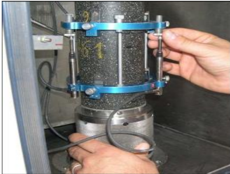
Figure 2. 6- Dispositif de mesure de l'augmentation de hauteur de l'échantillon (norme NF EN 12697-26)
