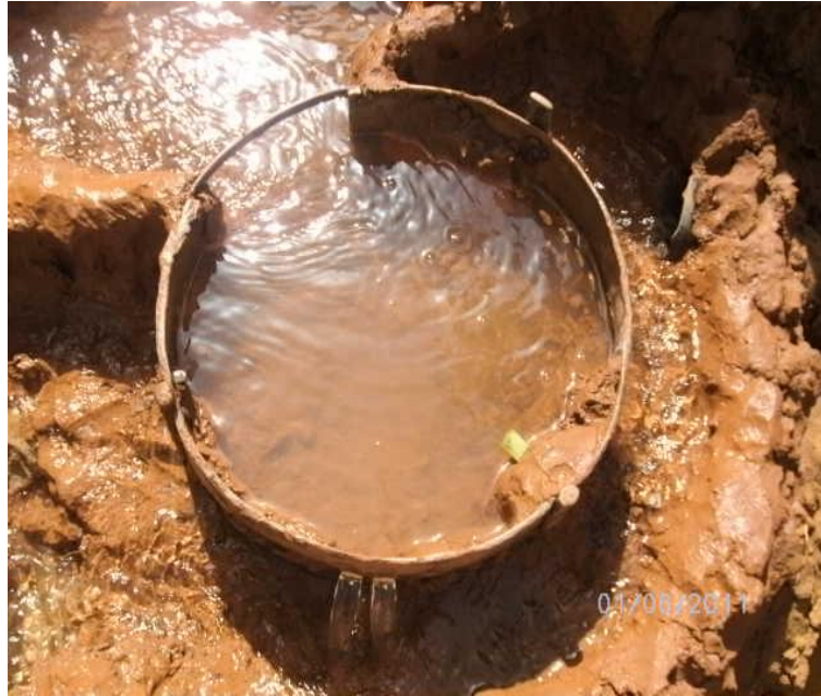
Figure. 5.10. Utilisation de la Chegfa lors d'une opération de mesure d'un faible débit (photo Salah Hebi, 2011)
