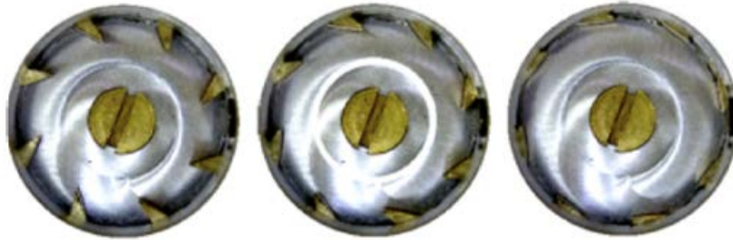
Fig. II. 8. Swirler radial à angle de pales variable. Trois positions sont représentées [83].
