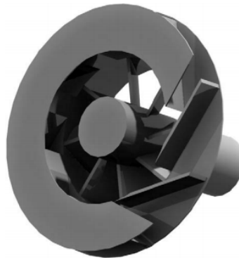
Fig. I. 1. Le concept du nouveau swirler avec les deux vannes tangentielles [26].
