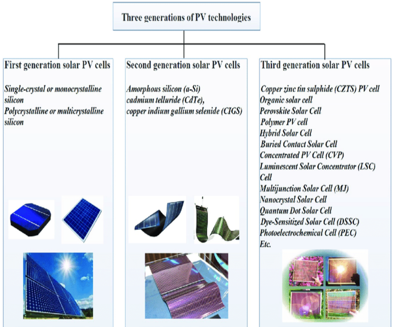
fig.I.7 Les trois générations des cellules photovoltaïques existantes[29].
