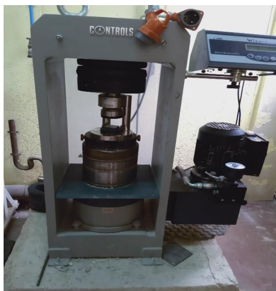
Figure 3.13: Dispositif d'une presse de compression.
