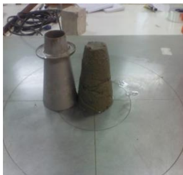
Affaissement d'un mortier non adjuvanté
