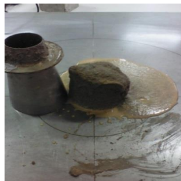
Etalement d'un mortier adjuvanté à 0.4% PC.
