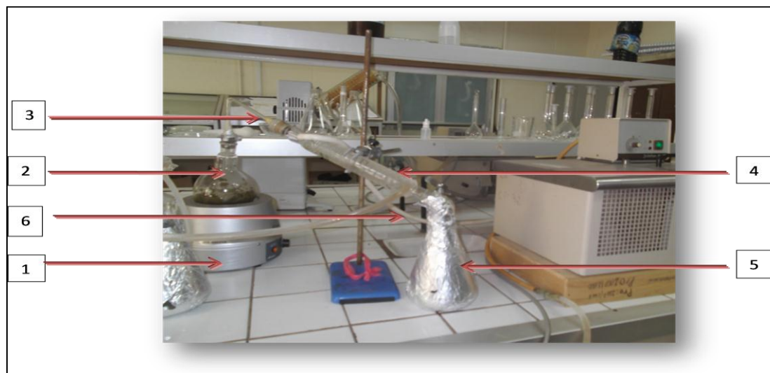
1. Chauffe ballon, 2. Ballon de 500 ml, 3. Tige coudée, 4. Réfrigérant, 5. Hydrodistillat, 6. Entrée et sortie d'eau.
