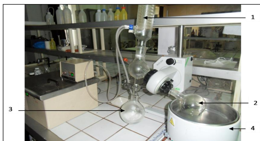
Figure 05 : Dispositif de séparation du solvant.
