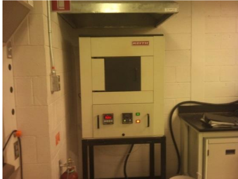
Figure 2. 8 : Four "KEITH" utilisé pour le chauffage des cylindres.
