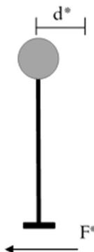
Figure 4-6. Système à un seul degré de liberté (SDOF) équivalent
