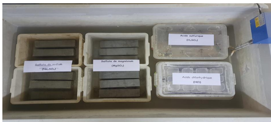
Figure 2.21. Conservation des éprouvettes dans les solutions agressives.
