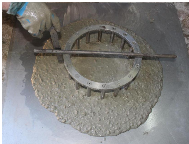
Figure 2.10. Essai à la couronne (J-Ring test)
