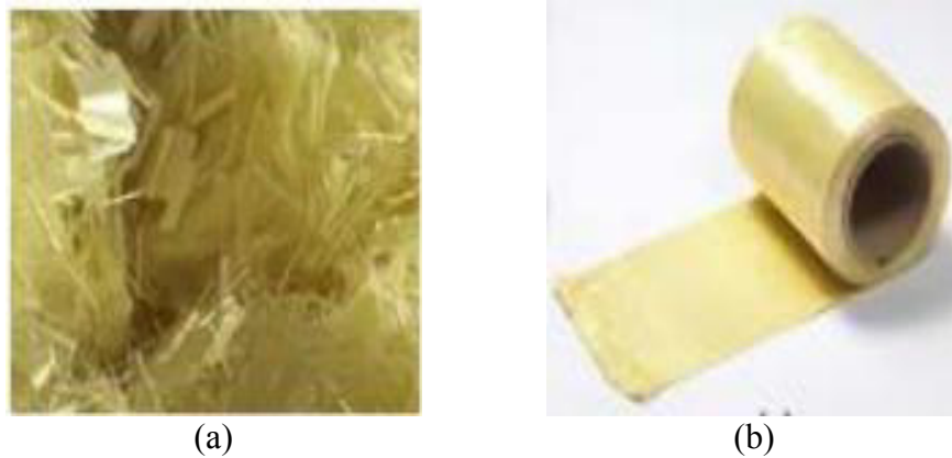
Figure I.18: Polymère renforcé de fibres d'aramide : a) Fibres d'aramide, b) Enveloppe en polymère renforcé de fibres d'aramide unidirectionnelles (Ostrowski et al. 2022).
