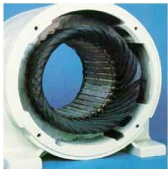
Damage dû à la surcharge
