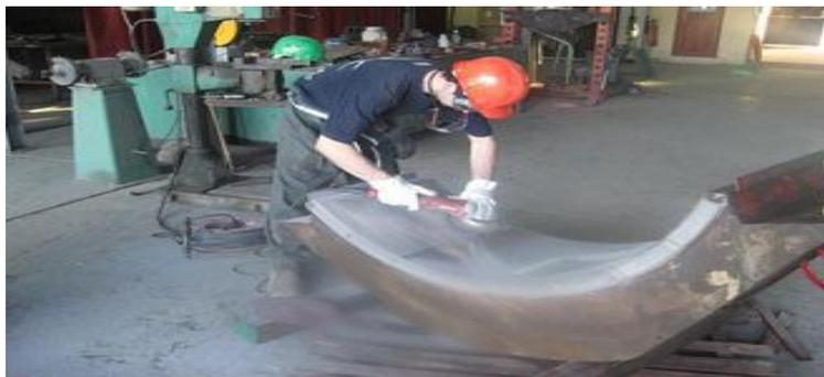
(c) Opération de détachement du régule endommagé du coussinet
