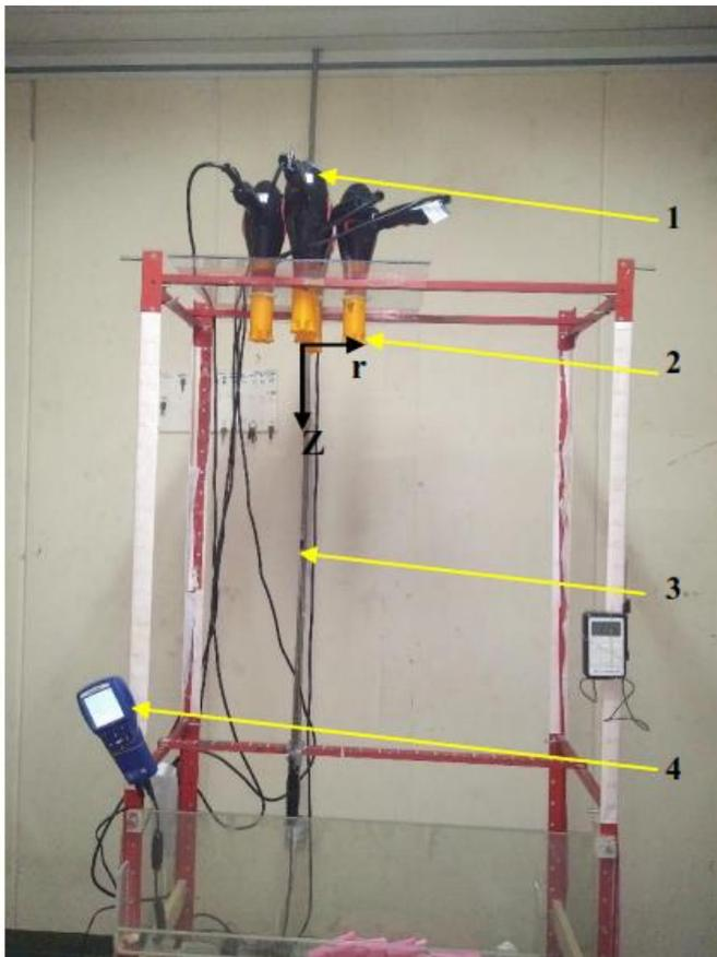
1- Sèche-cheveux ;2- Les Buses; 3- Sonde de thermo-anémomètre ;4- Thermo-anémomètre
