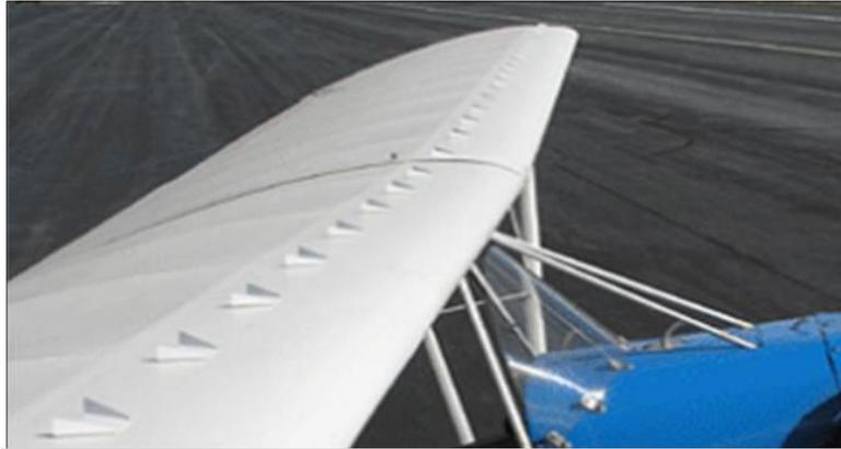
**Fig. I. 8 - Schéma d'un générateur de vortex passif installé sur le modèle de Stewart Headwind [54].**
