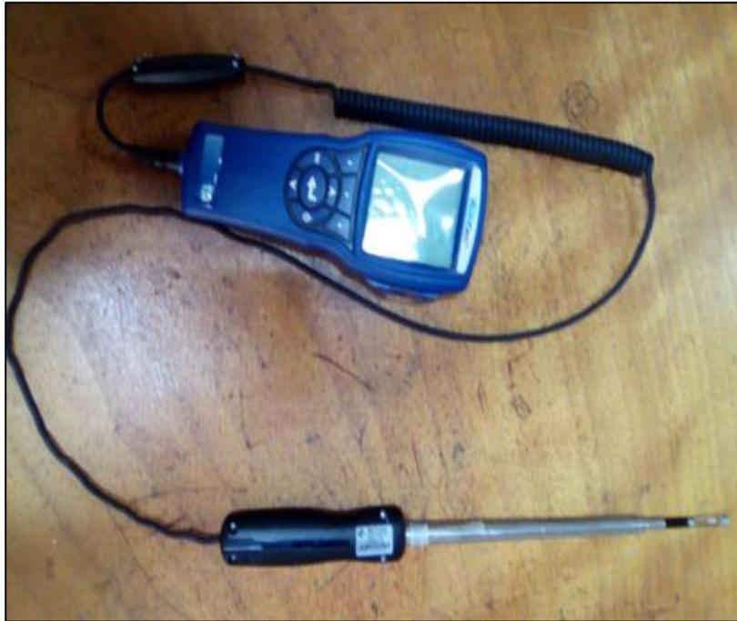
**Fig. III. 5 - Thermo-anémomètre.**
