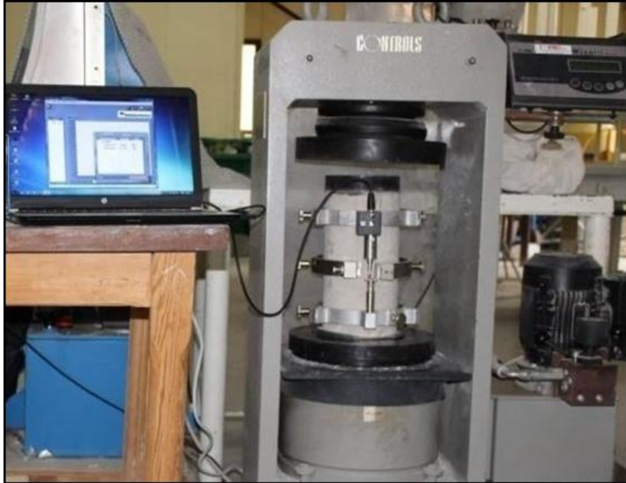
Figure 2. 10. Essai de mesure du module d'élasticité.
