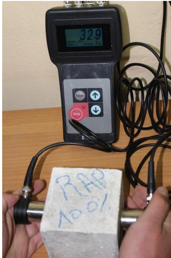
Figure 2. 12. Appareil de mesure de la vitesse d'impulsion.
