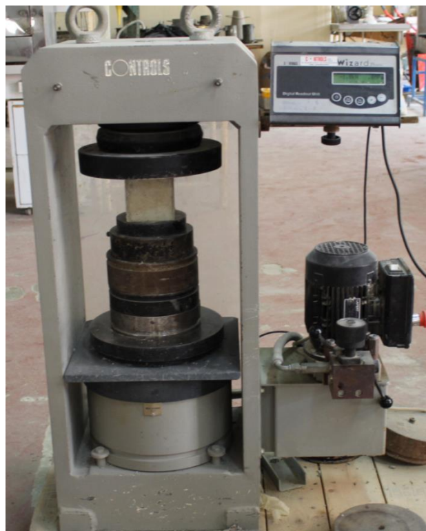
Figure 2. 8. Essai de résistance à la compression.
