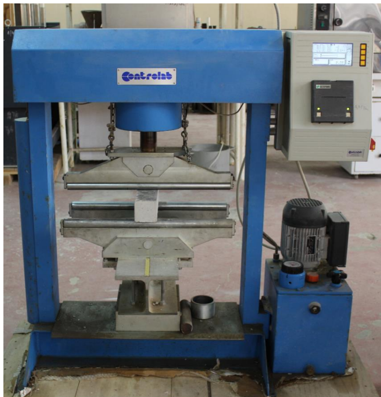
Figure 2. 9. Essai de traction par flexion trois points.
