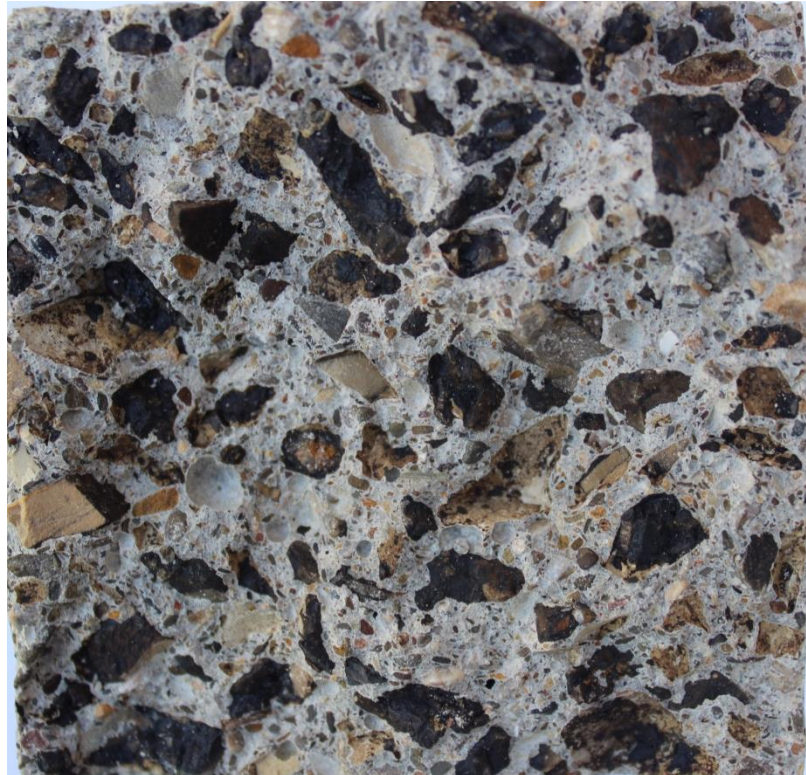
Figure 3. 11. Faciès d'une éprouvette BRAP-100 après essai de flexion.
