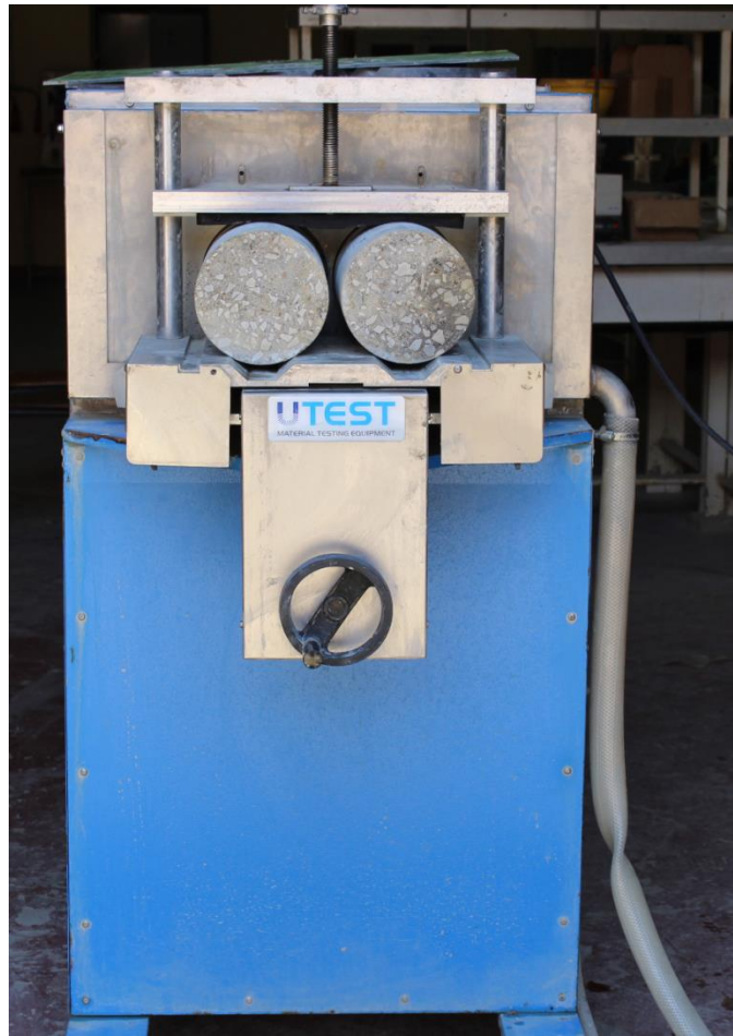
Figure 2. 11. Surfaçage des éprouvettes cylindriques.
