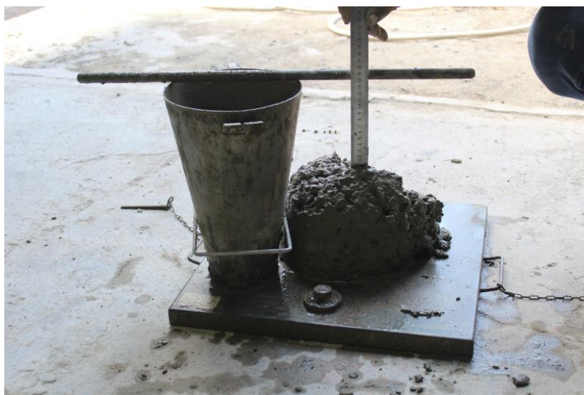
Figure 2. 6. Essais affaissement au cône d'Abrams.
