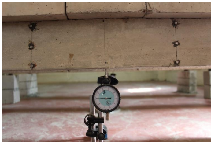
Figure 2. 22. Mesure des déformations du fluage et de la flèche.
