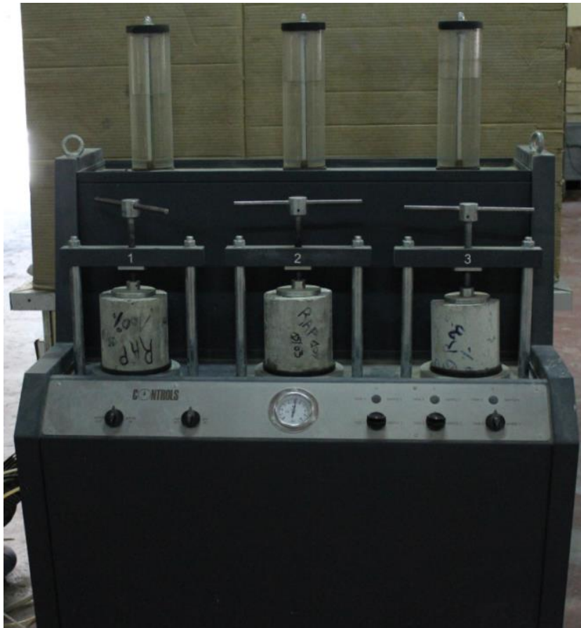
Figure 2. 15. Essai de perméabilité à l'eau.
