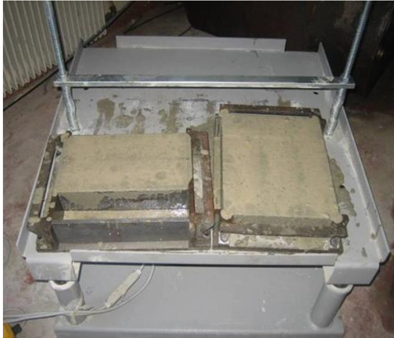
Figure 2. 4. Vibration des éprouvettes.
