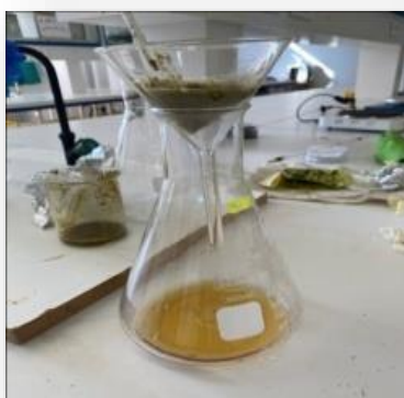
5- Filtration sur papier filtre (Wattman N°1).
