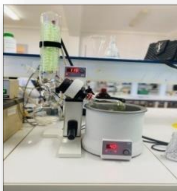
6- Evaporation sur un rotavapeur.
