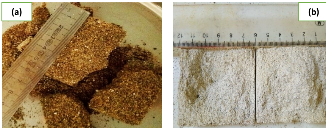
Figure 5. 5 : Échantillons après cisaillement, (a) Sable propre traité, (b) Mélange sable-argile kaolin traité.
