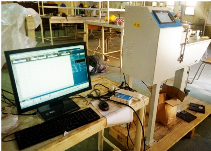
Figure 3. 10 : La boîte de cisaillement direct
