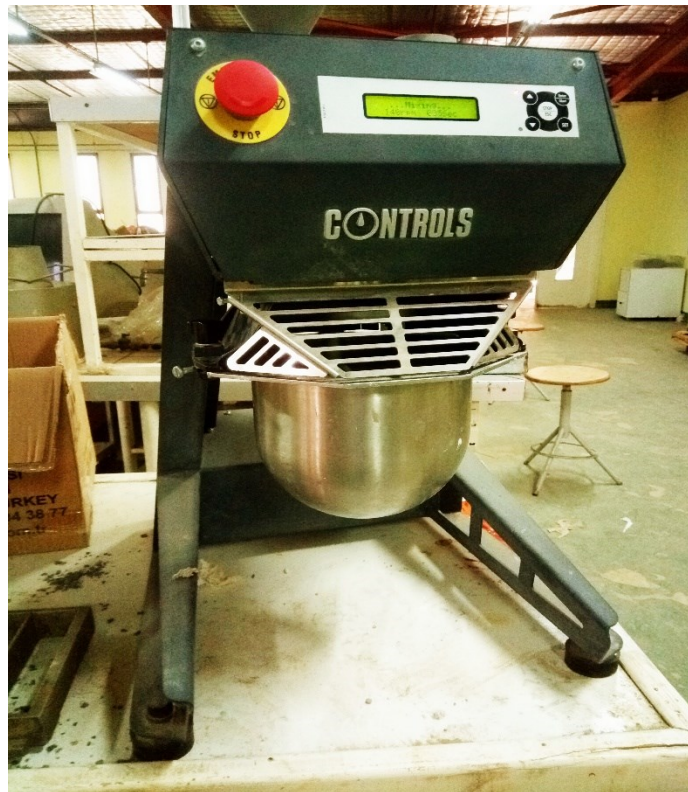
Figure 3. 13: malaxeur automatique utilisé pour le mélange
