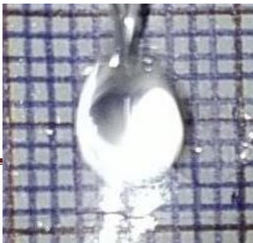
**Figure VI.5:** Technique photographique de mesure de la taille de la goutte.
