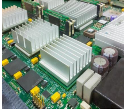
Figure I. 16: Illustration d'une ailette de refroidissement pour augmenter la surface d'échange convective [49]
