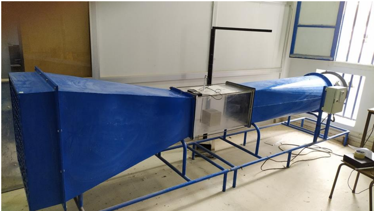
Figure VI. 1: Soufflerie aérodynamique située dans le laboratoire LASEM
