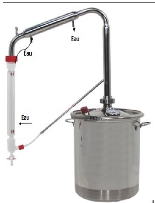
Montage D'entrainement a la vapeur d'eau (type Alambic)
