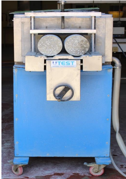
Figure 3.18. Surfaçage mécanique des éprouvettes cylindriques.
