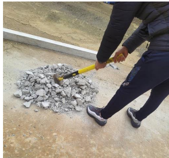
(2) Fragmentation des éprouvettes par une massette
