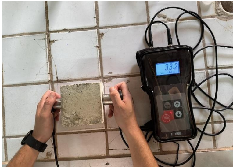
Figure 3.19. Appareil de mesure de la vitesse d'impulsion.
