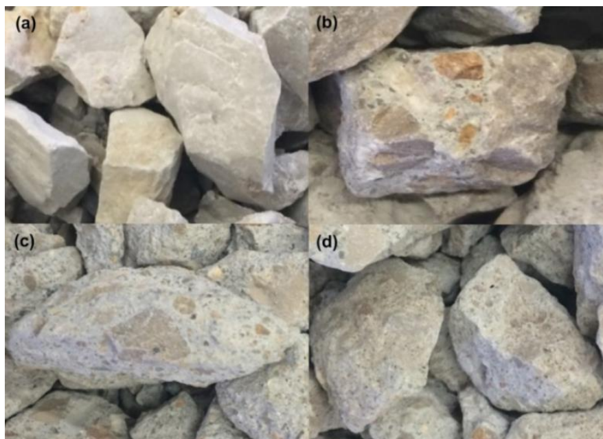
Figure 2.2. Morphologie des granulats : (a) GN; (b) GR1; (c) GR2; (d) GR3 [59].
