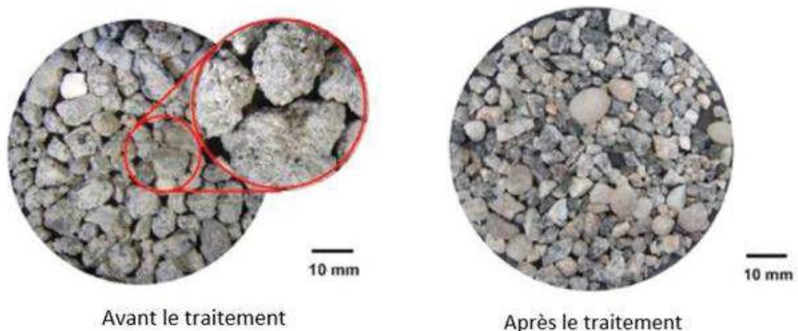
Figure 2.3. Morphologie de GR avant et après traitement avec 33 % HCl [66].
