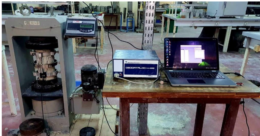
Figure 3.17. Dispositif de mesure du module d'élasticité.
