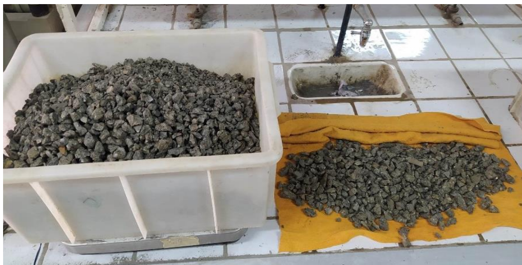
Figure 3.6. Elimination de l'eau adsorbée des GR pré-saturés.
