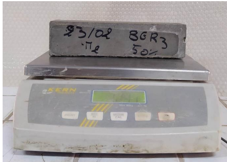
Figure 3.13. Mesure de la masse volumique du béton durci.
