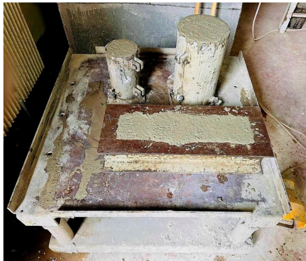
Figure 3.7. Vibration du béton.
