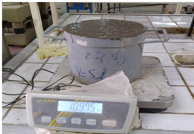
Figure 3.9. Mesure de la masse volumique du béton frais.
