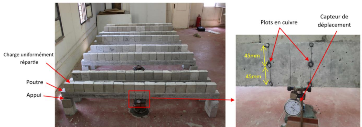
Figure 3.23. Essai de fluage en flexion.
