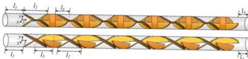
Figure I.22. géométries du tube équipé de différents mélangeurs statiques [45].
