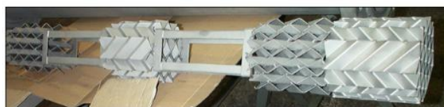
Figure I.7 : Dispersion gaz-liquide en mélangeur SMV [5]
