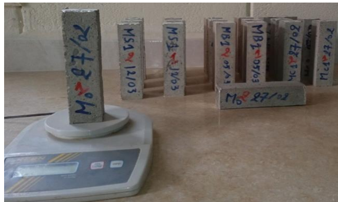
Figure 3.6 : Éprouvettes conservé dans l'air libre.
