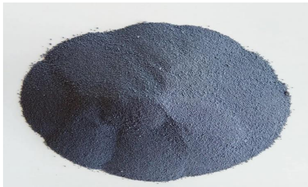
Figure 1.10 : Fumée de silice.
