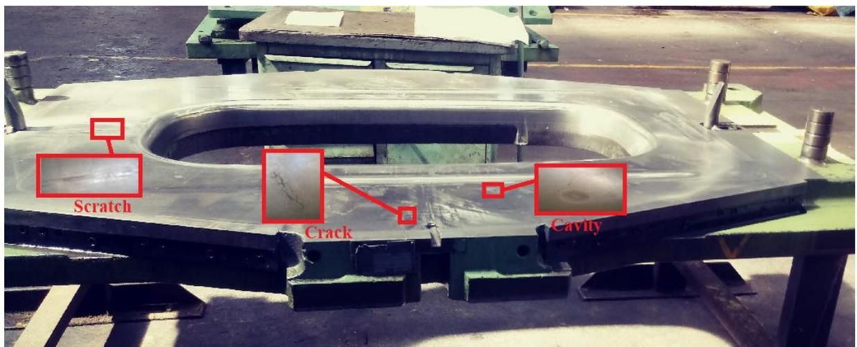
Figure 3-2: Différents défauts sur l'outil d'emboutissage profond (Matrice).
