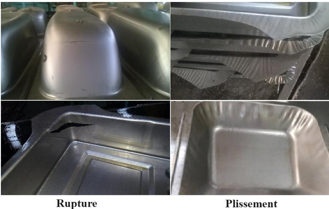
Figure 1-9 : Défauts résultant d'emboutissage profond à l'EIMS.
