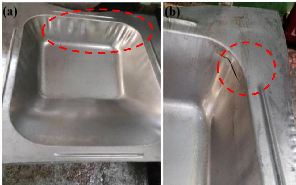
**Figure 4-4 : Défauts dans la caisse de la brouette lors de l'emboutissage : a) plissement, b) rupture.**
