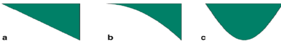
Figure II. 36- Représentation du paramètre variable de Winkler a) Linéaire, b) Parabolique et c) Sinusoïdale [179].
