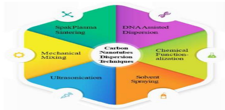
Figure I. 34 - Technique de dispersion CNT dans la matrice polymère [59].
