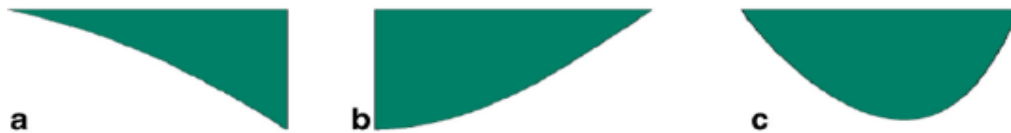
Figure II. 37- Représentation du paramètre variable de Winkler a) Polynomiale, b) Cousins et c) Exponentiel [179].
