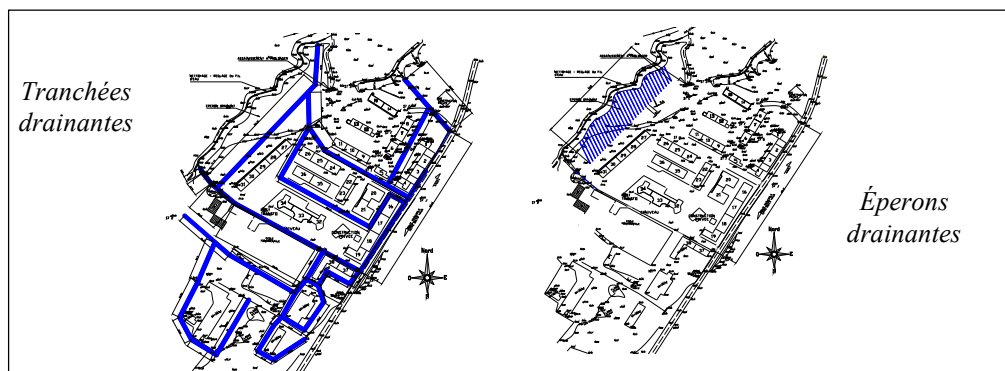
Figure IV. Implantation des tranchées et éperons drainantes
