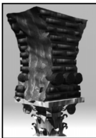
Figure 4 : Détails des chapiteaux de la Colonne avec la présence d'une couche de trois journaux de thuyas insérés entre Les briques maçonnerie.
