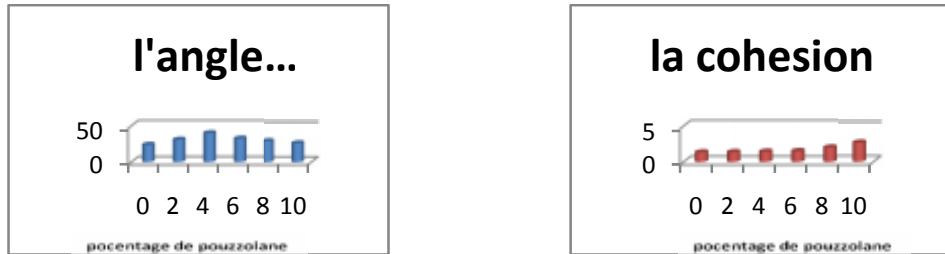
Figure 7. Histogrammes de variation de la cohésion et l'angle de frottement en fonction du pourcentage de pouzzolane (argile de Bourmadia).
