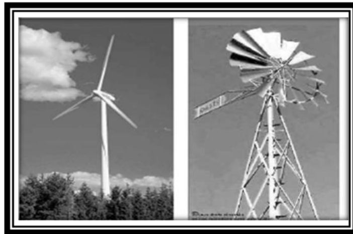
Figure II.15: Éoliennes à axe horizontal.
