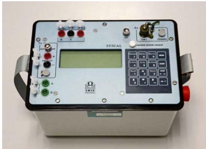
Figure IV.7. Matériel d'acquisition de quatre électrodes développé par IRIS
