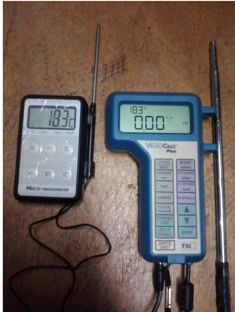
Figure (3.3). Thermometre digitale et thermo-anémomètre.
