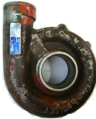
Figure (II.9) : Le compresseur centrifuge.
