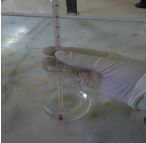
Figure 5: Solution de bicarbonate 0,2% chauffée pendant 10 à 20 minutes à 50-60°C
