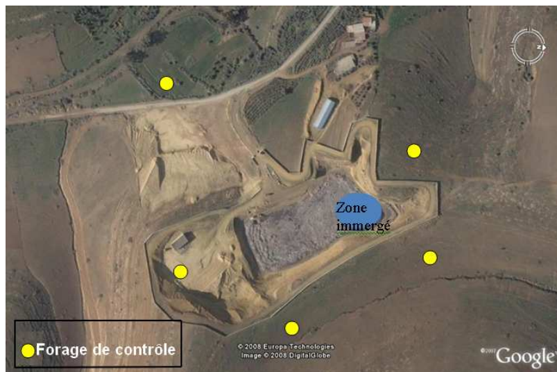
Figure 2. Répartition des forages de contrôle
