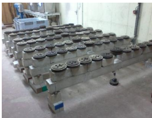
Fig.2. Mesure du fluage dur les poutres
