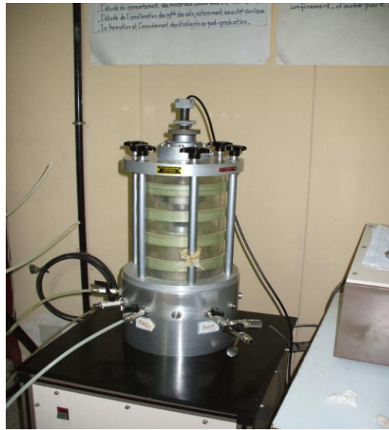
Figure3.7: Mise en place et remplissage de la cellule.
