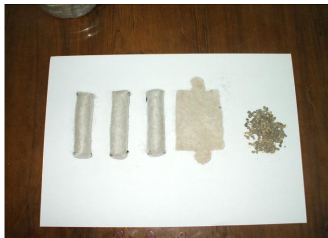
Figure 3.10 : Fabrication des colonnes ballastées
