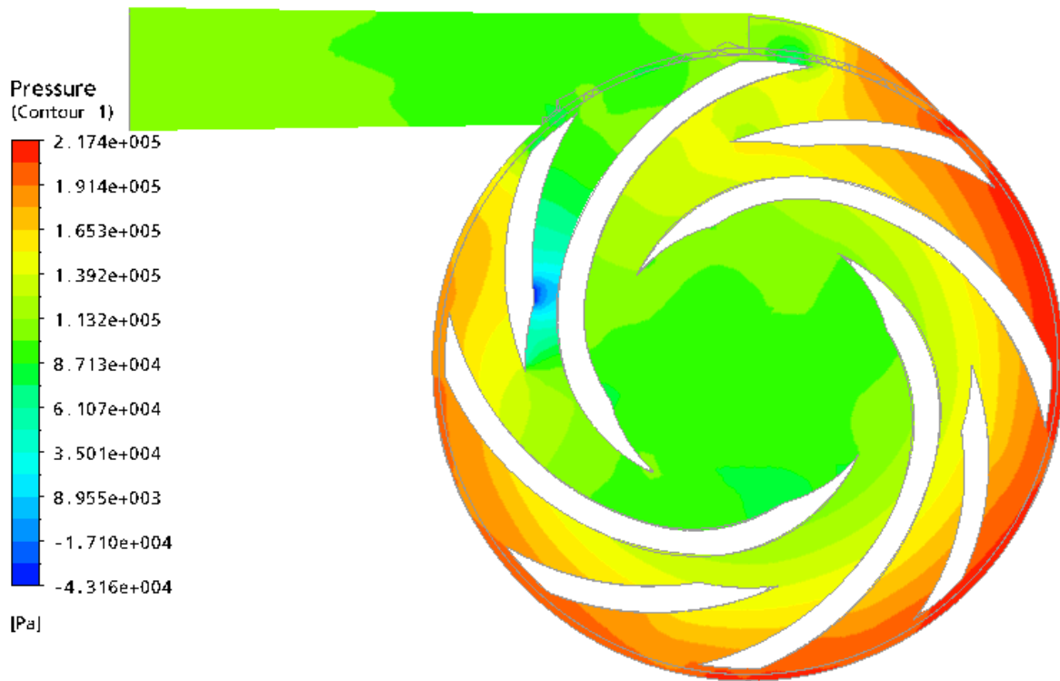
Figure IV.7. Champ de pression statique dans la pompe TE 47 à roue à aube courbée vers l'arrière ( \beta_2 < 90^\circ )
