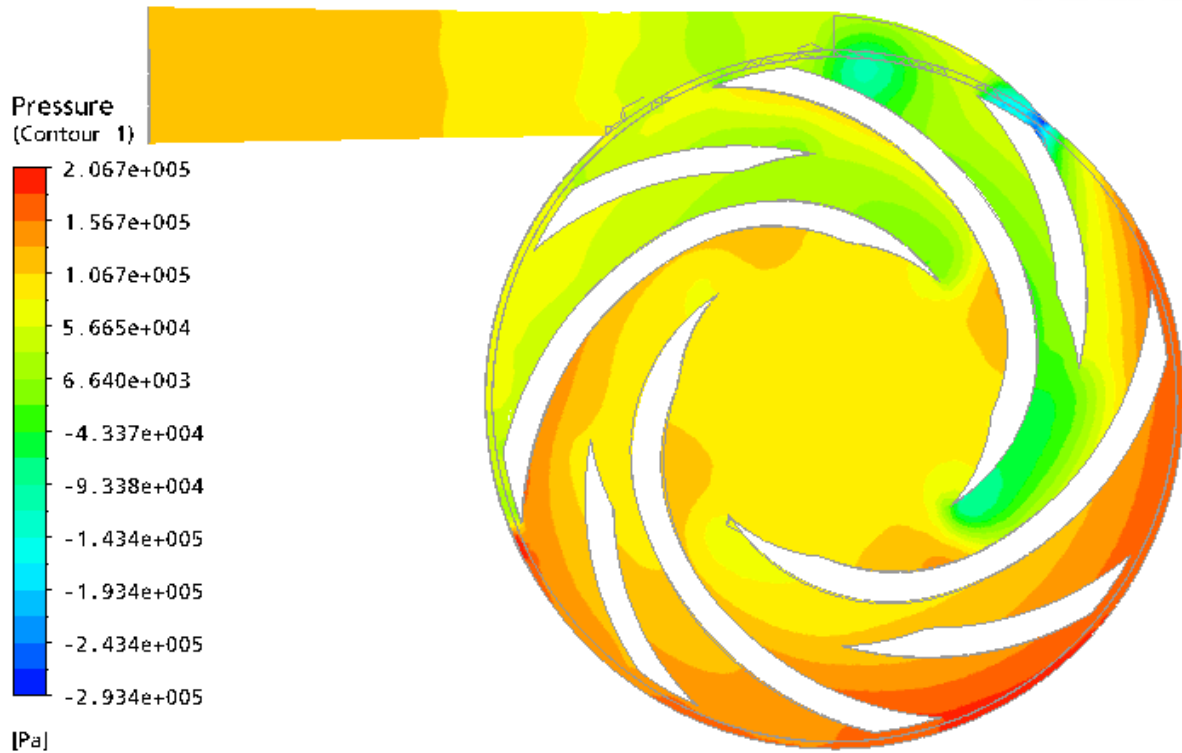
Figure IV.9. Champ de pression statique dans la pompe TE 47 à roue à aube courbée vers l'avant ( \beta_2 > 90^\circ )
