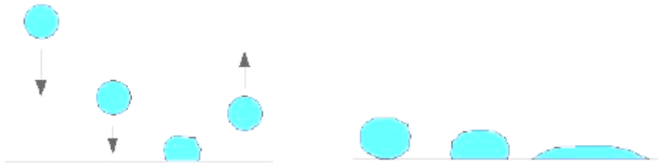
Figure II.13 : Comportement élastique et visqueux d'un échantillon viscoélastique [21].
