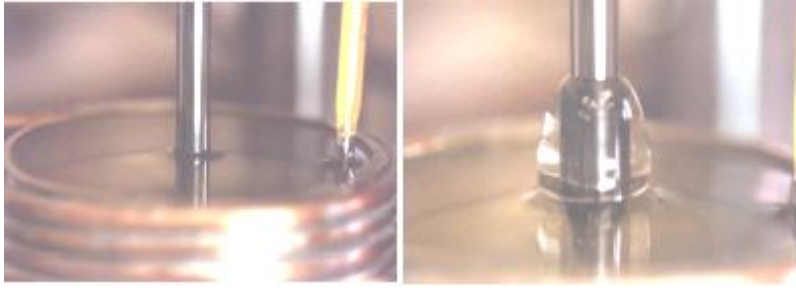
Photo II.1: Montée d'un fluide viscoélastique le long d'une tige en rotation [21].
