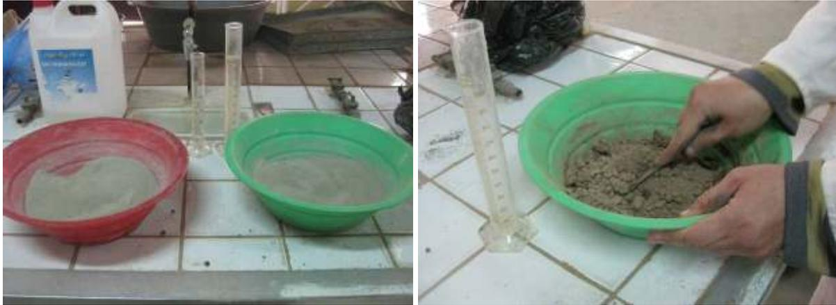
(a) Malaxage du matériau manuellement a une teneur en eau optimal
