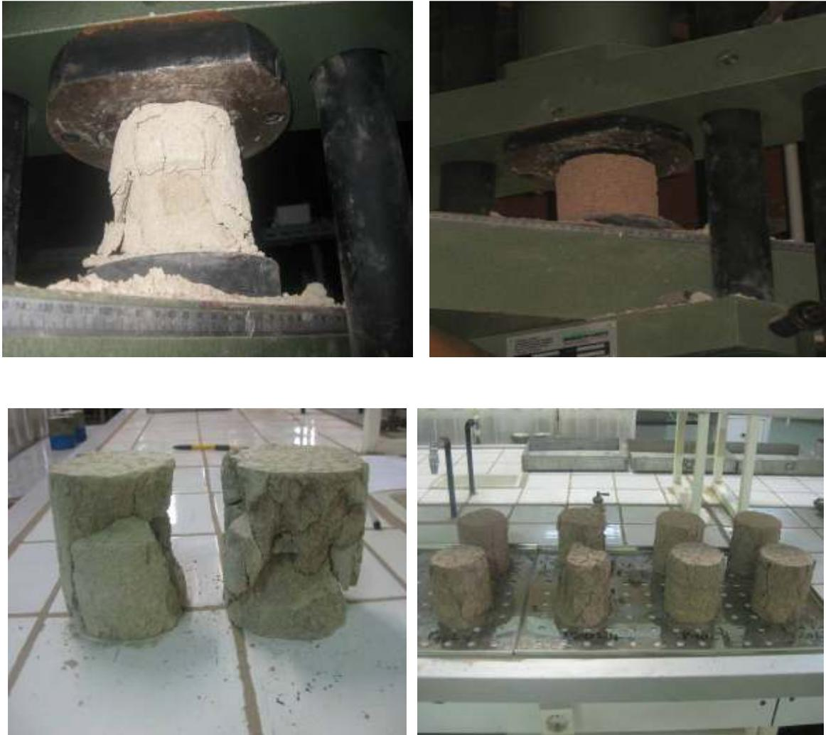
**Fig. 3.19-** Éprouvette après écrasement.
