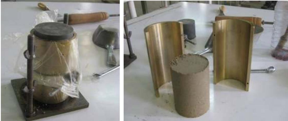
(d) Démoulage des éprouvettes après compactage
