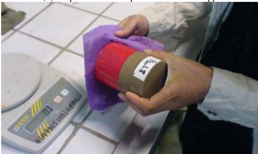
(c) enlèvement et assèchement d'éprouvette après un temps (t) avant le pesage.
