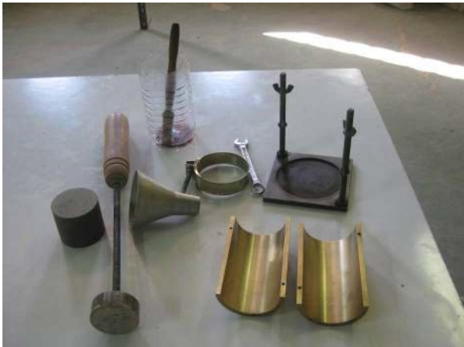
**Fig. 3. 14** Accessoire nécessaire pour l'exécution du compactage par CBR.
