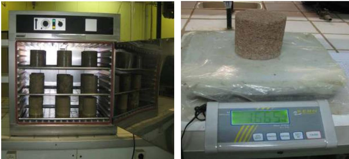
**Fig. 3. 18** (a) Séchage des échantillons à l'étuve (b) pesage après séchage.
