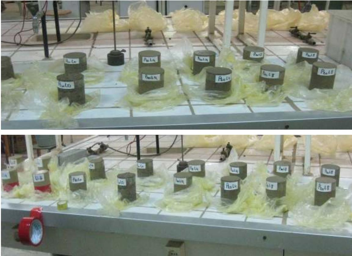
Fig. 3. 20- Eprouvettes destiné pour l'essai de la sorptivité.
