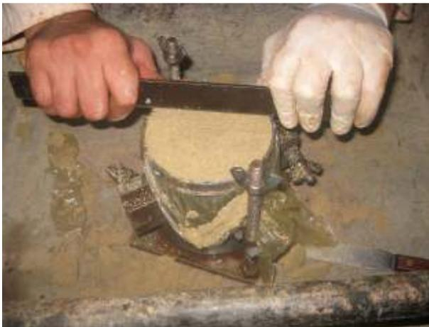
(e) arasement de l'éprouvette
