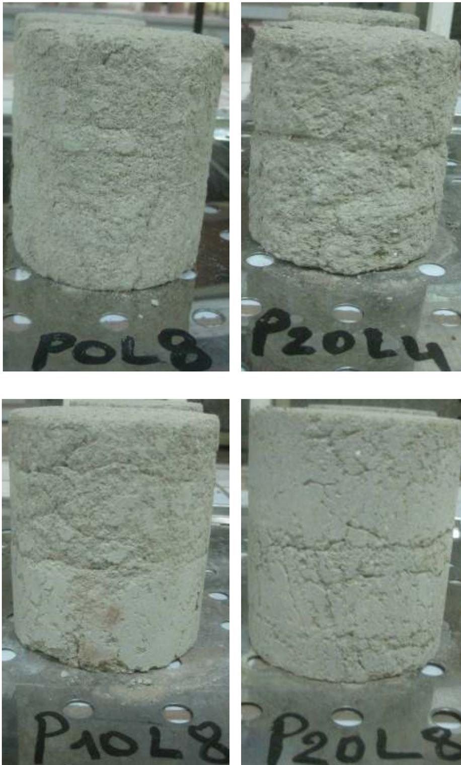
**Fig. 4.5-** Etat finale des échantillons du sol gris après 12 cycles.
