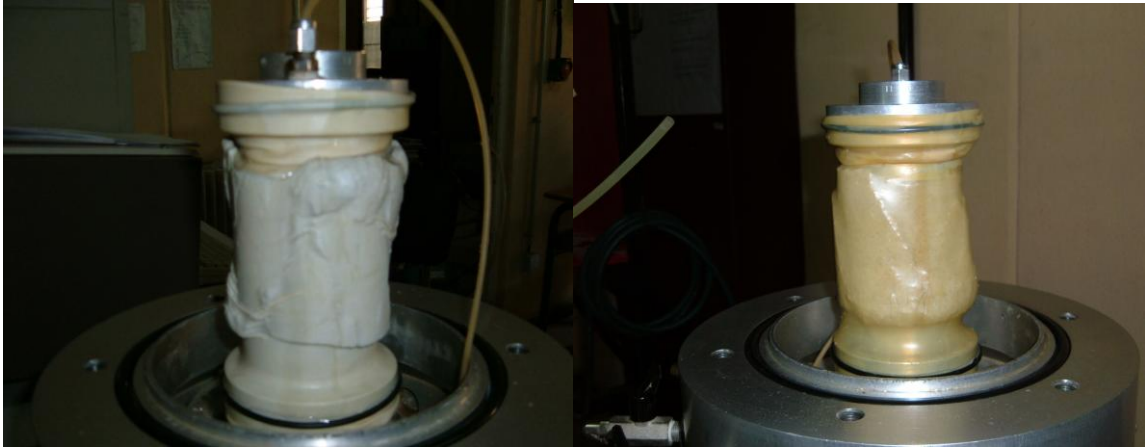
Fig. 6.19- Mode de rupture.
