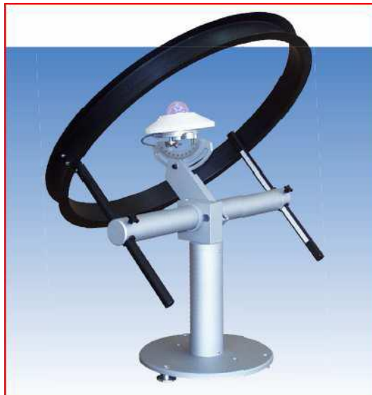
Fig. 1.26 Pyranomètre muni d'un pare-soleil et destiné à la mesure du rayonnement solaire diffus.
