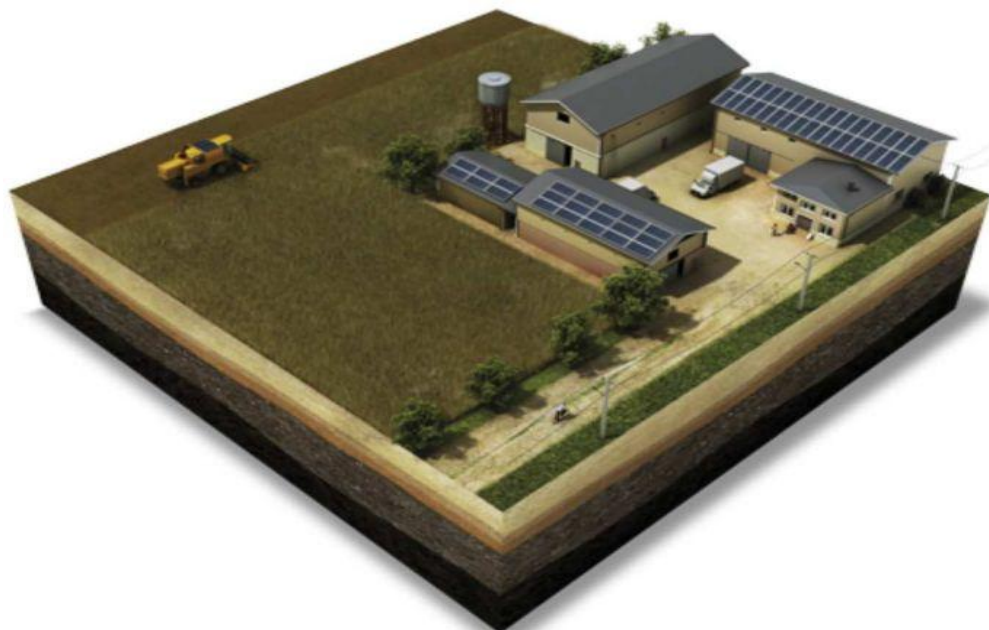
Fig 4-1 : Ferme agricole équipée par des modules solaires photovoltaïques et raccordée au réseau [48].
