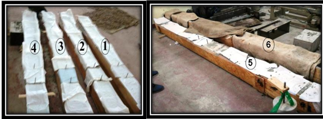
Figure 5.7 : Conservation des poutres avant la mise en charge
