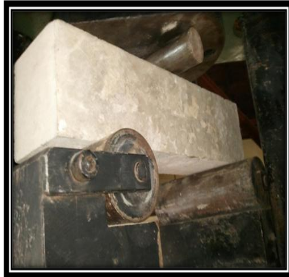
Figure 5.4: Essai de flexion sur prisme
