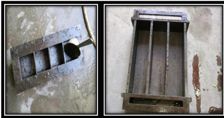
a) Cubiques ( 10 \times 10 \times 10 cm 3 ) b) Prismatiques ( 7 \times 7 \times 28 cm 3 )
