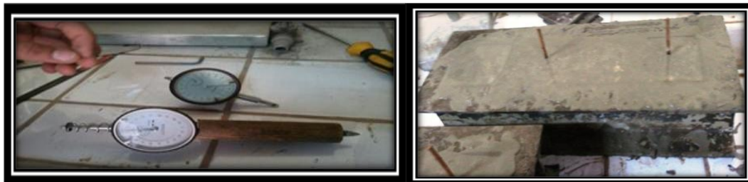
Figure 5.8 : Dispositif de mesure de déformation de retrait
