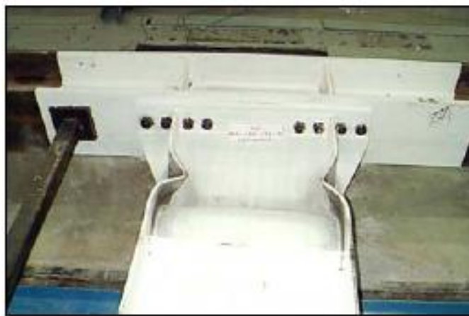
a). Poutre de 8 boulons avec raidissages
