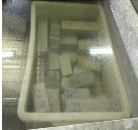
**Figure 3.5 :** Bac pour conservation des éprouvettes.
