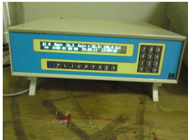
*Figure 3.14 : Chaîne d'acquisition des températures.*
