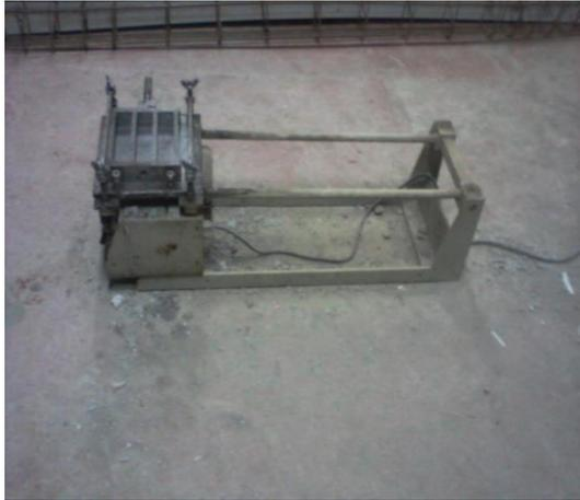
**Figure 3.4:** Table à secousses pour le compactage des éprouvettes.
