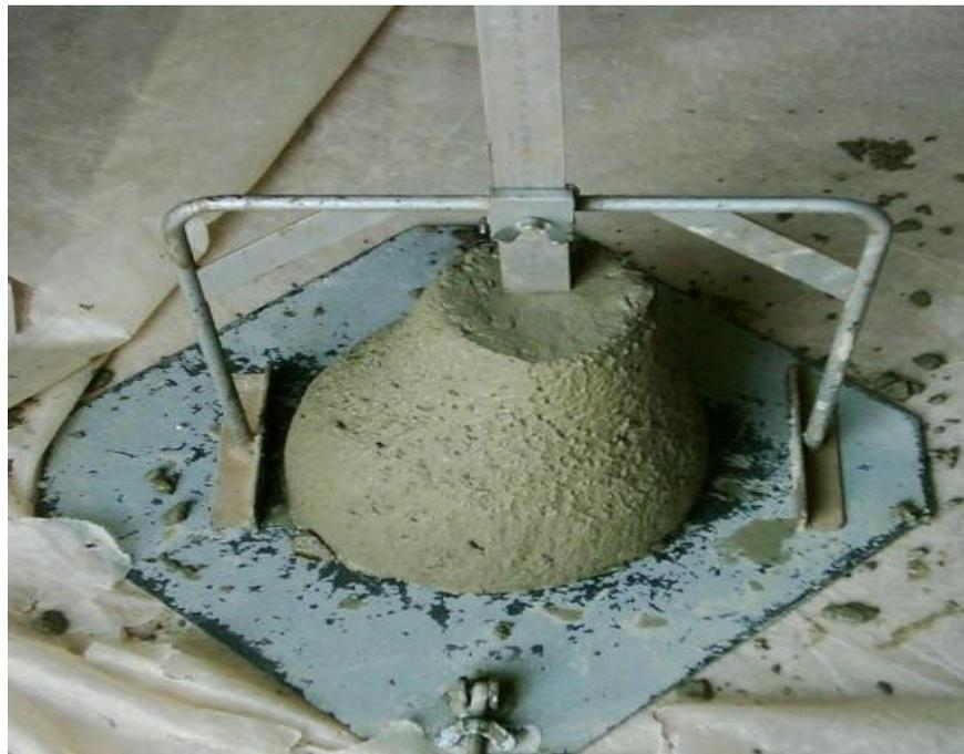
**Figure 5.2-** Mesure de l'affaissement à l'aide du cône d'Abrams.
