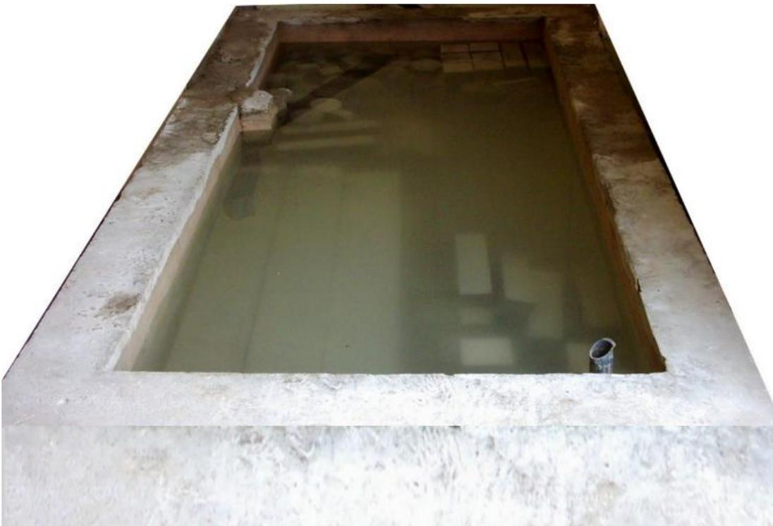
**Figure 5.4-** Conservation des éprouvettes après démoulage.
