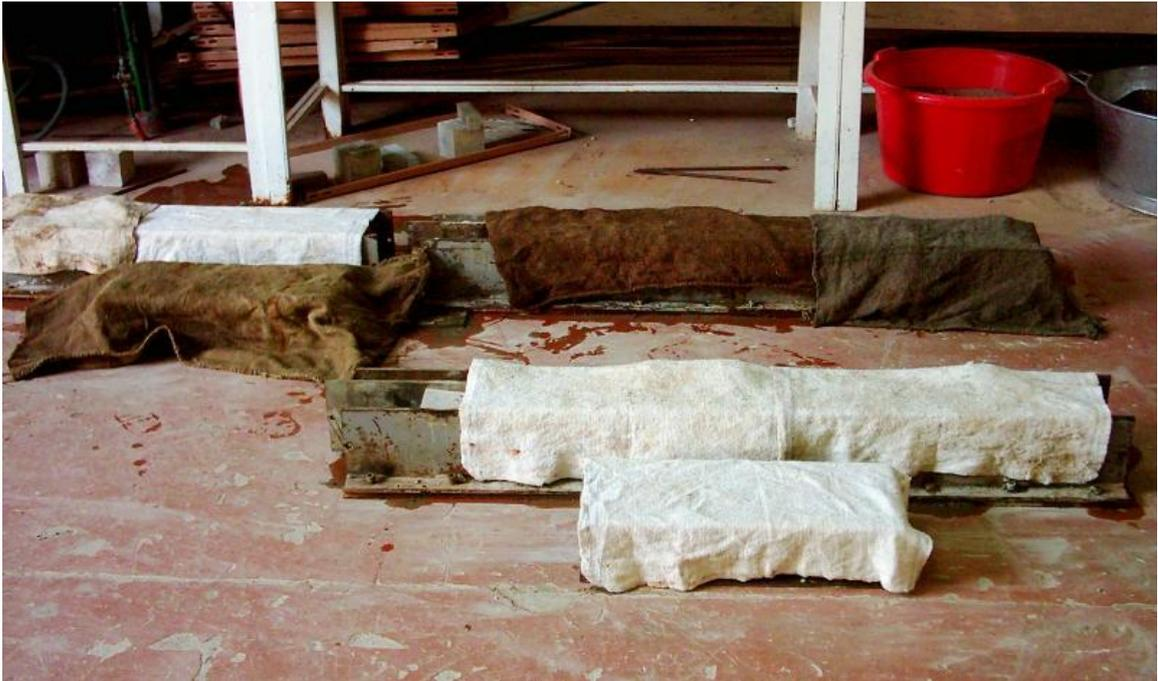
**Figure 5.3-** Conservation des éprouvettes avant démoulage.
