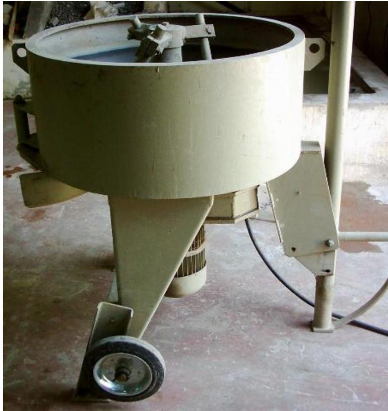
**Figure 5.1-** Malaxeur à béton.
