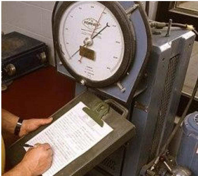
**Figure 5.5-** Essai d'écrasement des éprouvettes.
