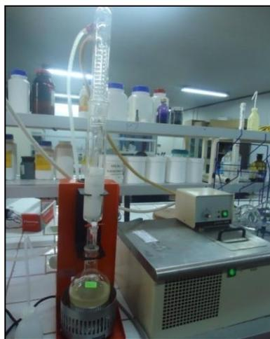
**Figure 07** : Dispositif d'extraction de l'huile d'argan (Soxhlet).
