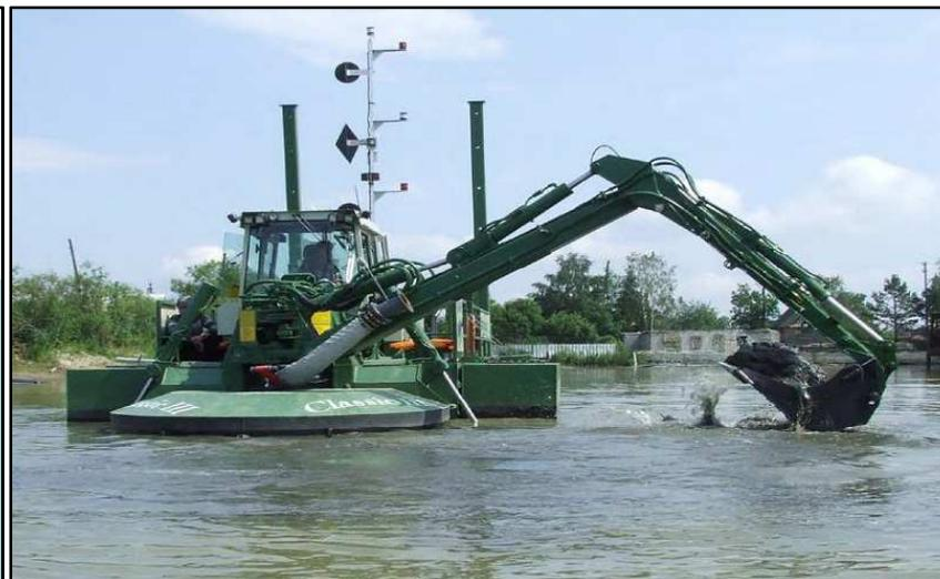
Figure VI.13: Rayon d'action de la drague mécanique. Photo VI.11: Drague mécanique.
