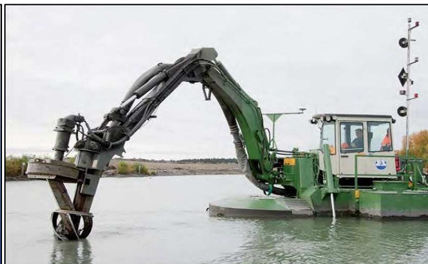
Figure VI.14 : Rayon d'action de la drague hydraulique.
